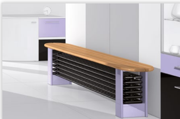
Grzejnik kolumnowy LaserLine Bank. Dekoracyjny grzejnik kolumnowy z precyzyjnej rury stalowej z kompletnym niewidocznym spawaniem laserowym. LaserLine Bank to połączenie nowoczesnych technologii grzewczych, innowacyjnego designu i funkcjonalności (praktyczna ławeczka lub przydatna półka). Występuje w różnych kolorach i wymiarach. Wymiary (wys./szer./głęb.) [mm]: (422-572)/(1850-3150)/370.
