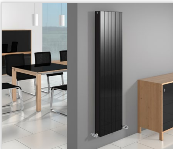
Grzejnik konwektorowy Kontec. Składa się ze zgrzewanych, przewodzących wodę elementów grzewczych wykonanych z przewodów stalowych o przekroju prostokątnym. Wyposażenie fabryczne: osłony boczne (w wersji poziomej – pokrywa górna). Wersja: standardowa oraz wysokociśnieniowa. Dostępny w różnych kolorach. Dł./wys. wersji poziomej w zależności od typu: 500-1400 mm (krok co 100 mm) i 1400-4000 mm (krok co 200 mm)/70, 142, 214, 286 dla modelu KK i KK-S i 358, 430, 502, 574, 646 i 790 mm dla modelu KH. Szer./wys. wersji pionowej: 142-862 mm (krok co 72 mm)/1600, 1800, 2000 i 2200 mm.
