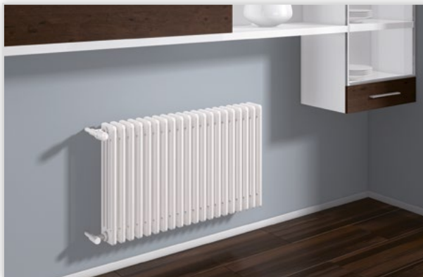
Grzejnik kolumnowy LaserLine Standard. Dekoracyjne grzejniki kolumnowe z precyzyjnej rury stalowej z kompletnym niewidocznym spawaniem laserowym. Rury i głowice są spłaszczane na stronach zewnętrznych dla podwyższenia mocy cieplnej. Podłączenia 4 x GW 1/2" (na przedniej stronie), pasuje również do rozstawu króćców przyłączeniowych starych grzejników żeliwnych. Dostępne w szerokiej palecie kolorów RAL. Występuje również w formie zaworowej z podłączeniem środkowym. Wymiary (wys./szer./głęb.) [mm]: (155-3000)/(200-2500)/(63-215).
